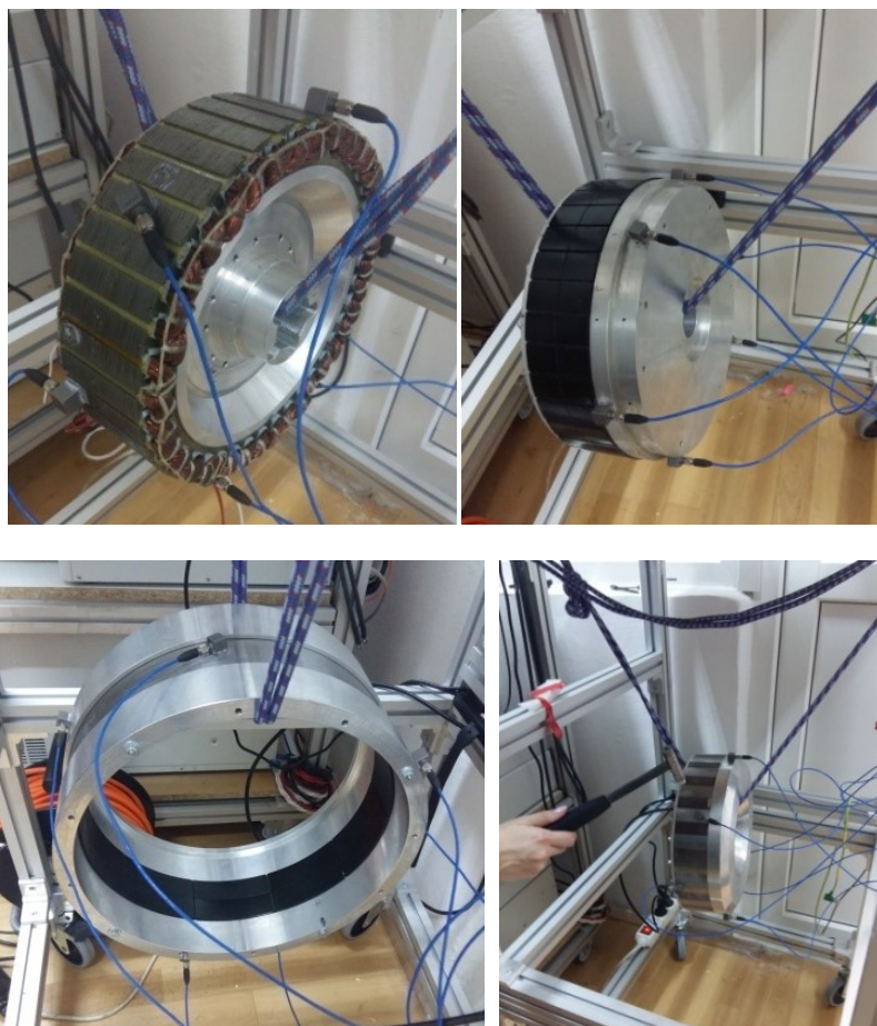
Fig.10. Modalitate măsurători efectuate pe structurile moto-reductorului magnetic cu transmisie în trepte (în imagine este prezentat rotorul reductorului magnetic – stânga – și partea fixă interioară a acestuia – dreapta).
